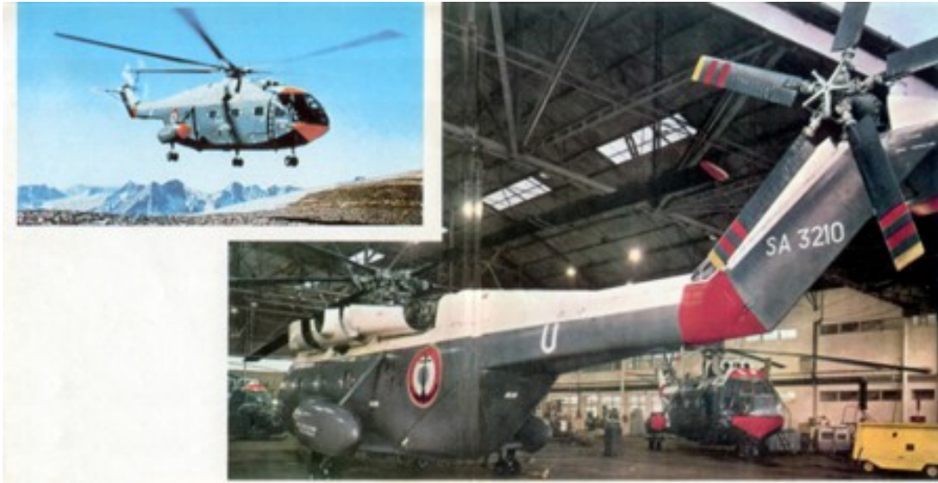
El Super Frelon, proyectado y construido en Francia, es el helicóptero europeo más interesante. Está accionado por tres potentes turbinas y es anfibia. Arriba, el Frelon en vuelo. A la derecha, una fase del montaje en los talleres de Marignane.
