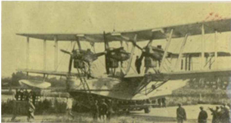
El gigantesco avión bombardero inglés Iris II (1927) con tres motores Rolls. Royce de 700 CV.
